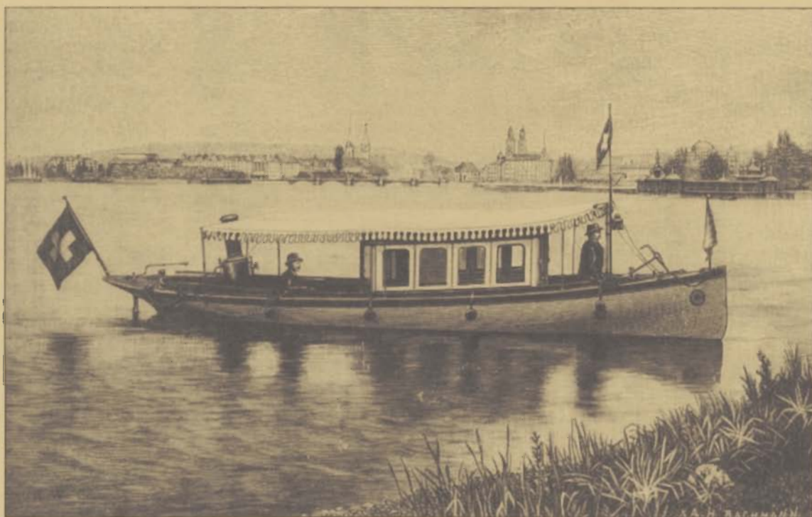
Naphtaboot mit Cabine, 11 m lang, 1.9 m breit.
